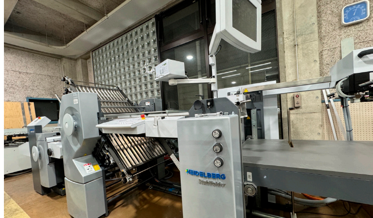
墨田区東駒形・本所の2工場には複雑な製本に対応する多種多様な設備が並び、写真は複雑な折り加工にも対応する最新式のドイツ製折機。
